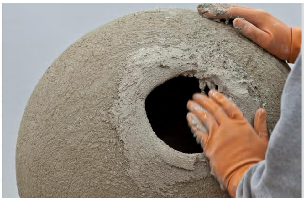
Bild links: Die Kugelöffnung bedarf noch einer Nacharbeit, sofern sie sichtbar bleiben soll.
