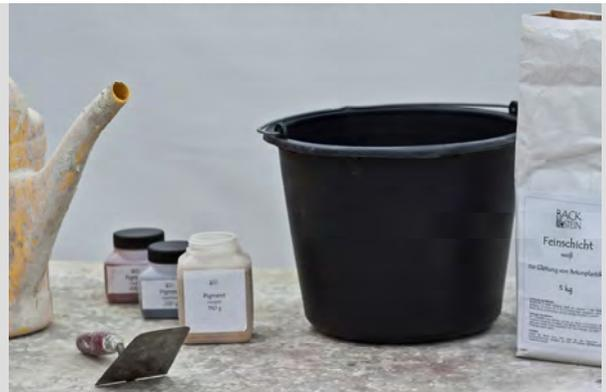
*Der Feinschichtmörtel wird mit Wasser zu einer steifen Suppe angemacht. Wenn die Suppe zu flüssig ist, sandet der Mörtel später von der Oberfläche wieder ab. Wenn sie zu steif ist, tut man sich schwer mit dem Auftragen und Ausstreichen.*
