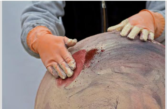
Die Pigmente werden in den frischen Mörtel eingerieben und dadurch auf der Oberfläche fixiert. Wenn der Mörtel schon leicht abgebinden hat, funktioniert das nicht mehr.
