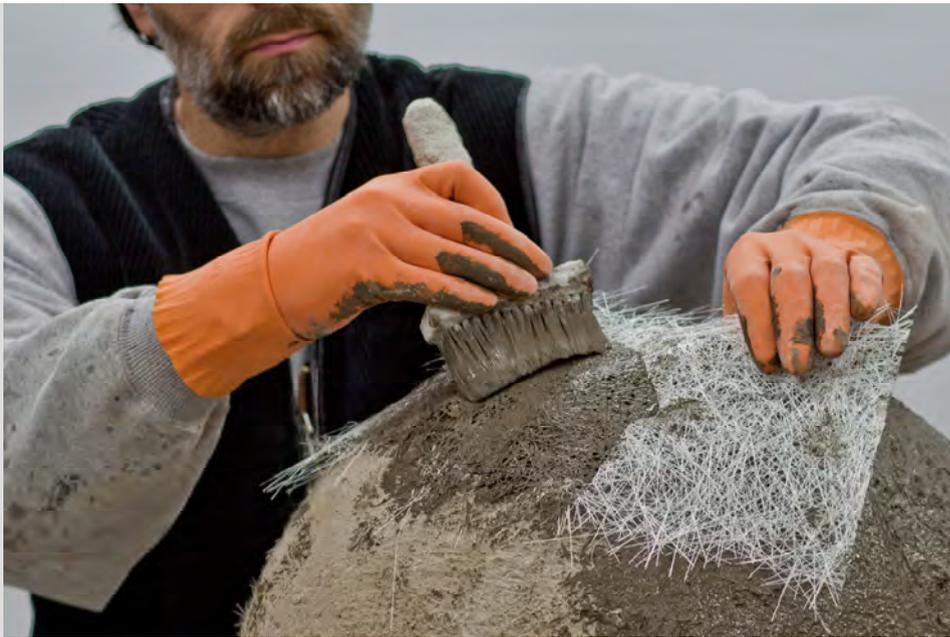
Mit Hilfe der Zementschlämme werden die Glasfasern fest im Beton verankert. Die Glasfasermatte wird dafür auf die benetzte Oberfläche gelegt und in weitere Schlämme eingebettet. Es ist wichtig, die Fasern vollständig zu tränken, jedoch sollen auch hier wieder keine Pfützen entstehen. Durch den Kontakt mit Wasser lösen sich die einzelnen Fasern der Matte voneinander und schmiegen sich gefügig der Kugelkrümmung an.
