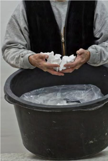
Als weiche Bettung für die Kugel eignen sich Verpackungschips oder einfach zerkrümelte Styroporreste, die man in einen Mörtelkübel gibt und mit einem Plastiksack beisammen hält.
