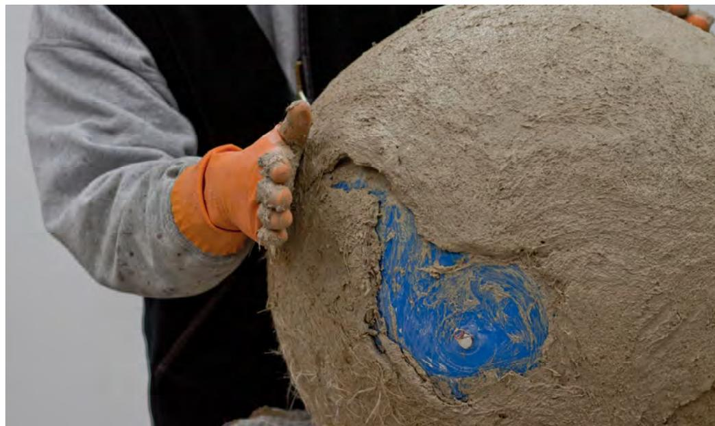
*Beim Betonieren der zweiten Kugelhälfte wird der Mörtel am Übergang zwischen den beiden Halbkugelschalen wieder dünn ausgestrichen, damit sich Nord- und Südhalbkugel gut miteinander verbinden.*
