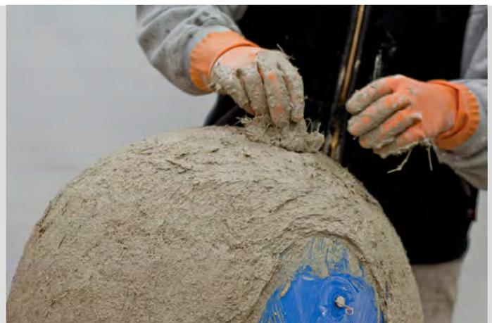
*Die Löcher, die durch das Festhalten des Balls und das Probebohren entstanden sind, werden am Ende mit dem restlichen Mörtel geschlossen.*
