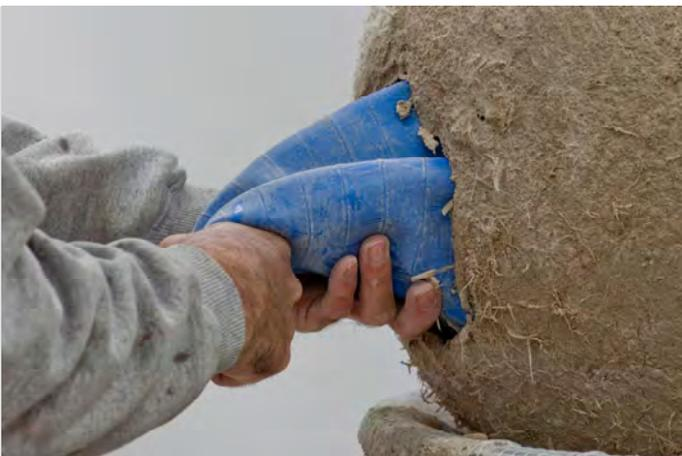
*Die Entnahme des Gymnastikballs muss behutsam erfolgen, weil der junge Beton ja erst wenig Festigkeit erlangt hat. Das Luftablassen kann man übrigens beschleunigen, indem man die Luft aus dem Ball mit dem Staubsauger absaugt.*
