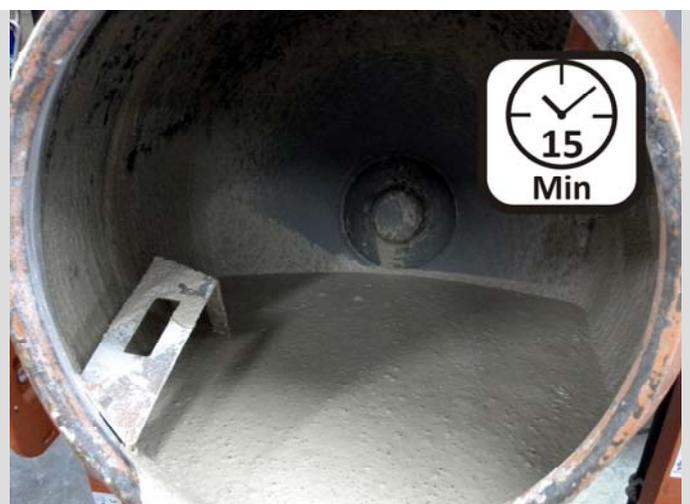
zu Mal nicht genauestens beibehalten werden, besteht die Gefahr, dass sich später die einzelnen Schüttlagen an der Oberfläche des Gussstücks abzeichnen. Es hat sich in solchen Fällen als praktikabel erwiesen, den gemischten Beton zunächst in handlichen Eimern zu sammeln bis genug Masse für den gesamten Guss zur Verfügung steht, dann alle Eimer mit dem Rührwerk kurz aufzurühren und zügig nacheinander in die Form zu entleeren.
