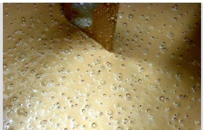
Der Mischvorgang wird beendet, und beim Blick in den Mischer zeigt sich ein intensives Blubbern an der Oberfläche. Der Beton beginnt also bereits zu entlüften.
