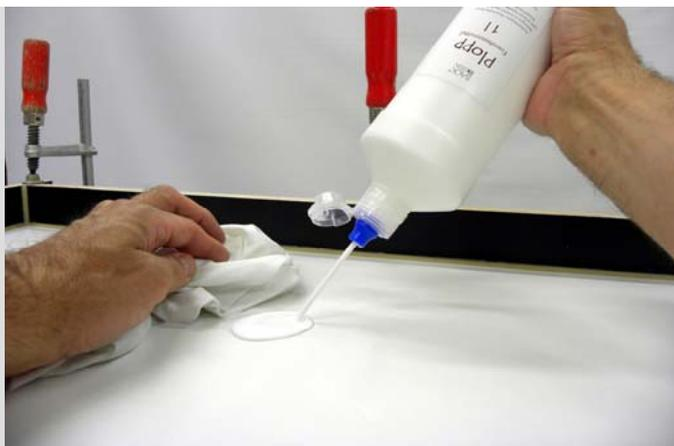
Mit dem passenden Trennmittel wird die Form dünn eingerieben. Es soll kein sichtbarer Rückstand zu sehen sein, nur ein leichter Glanz.
