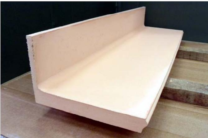
Bei dieser 4 cm dicken Treppenstufe mit 2 cm dicker Aufkantung besteht die Bewehrung aus AR-Glasfasern. Die einzelnen Arbeitsschritte werden in den folgenden Bildern gezeigt.
