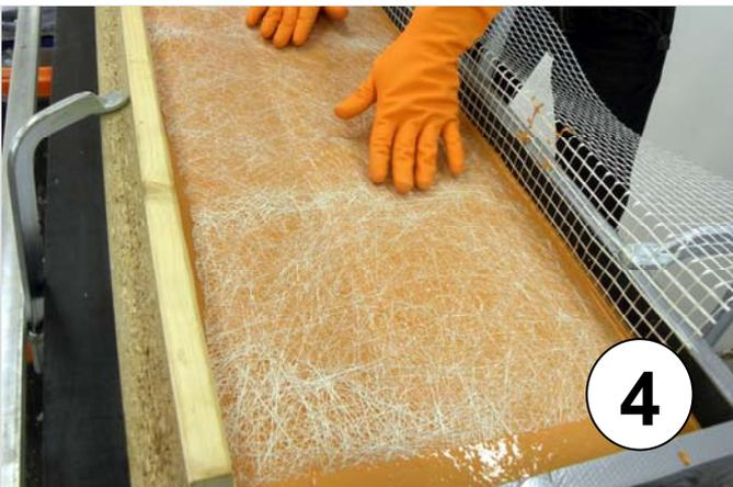
Auf die 1 cm dicke Betonschicht wird Glasfasermatte gelegt, die verhindern soll, dass sich das regelmäßige Gittergewebe später an der Oberfläche des Betons abzeichnet.
