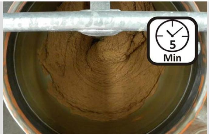
Nach fünf Minuten Mischzeit ist schon ein homogener Brei entstanden. Es muss aber noch einige Minuten lang weitergemischt werden, bis der Beton richtig fließt.
