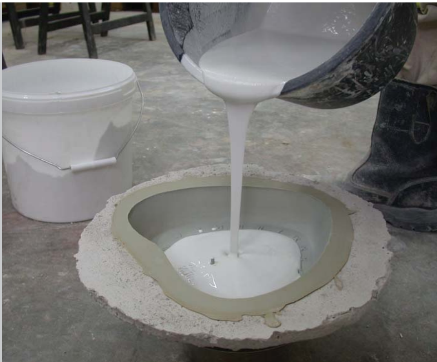
Ein Vergussmörtel läuft wie Honig in die Form. Wenn man ihn in dünnem Strahl hinein gießt, kann man unerwünschte Lufteinschlüsse vermeiden. Rütteln darf man ihn nicht, denn durch das enthaltene Fließmittel würde er sich dann entmischen.
