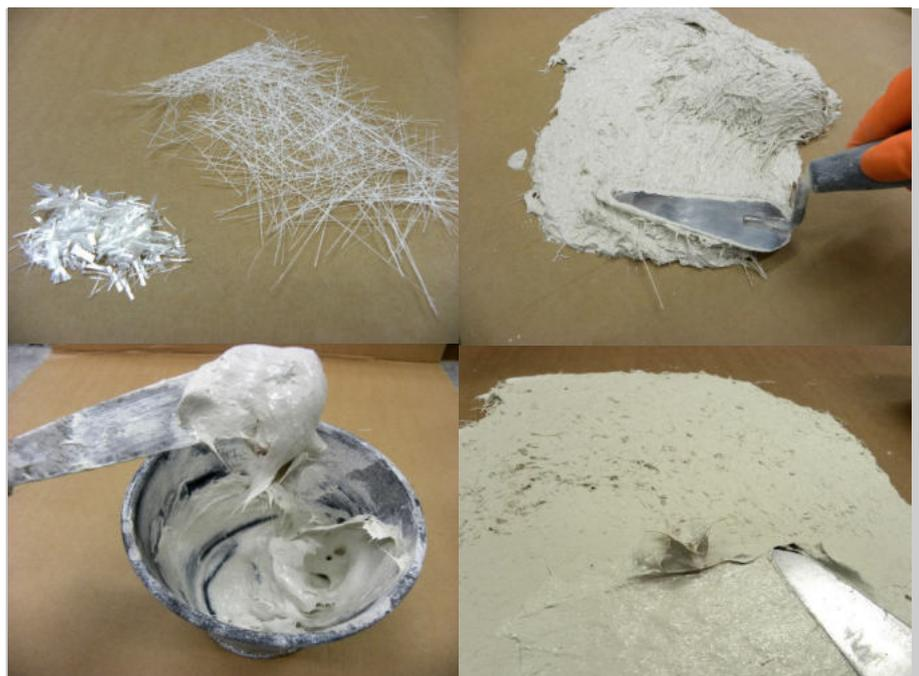
Bei der Beton-Ultraleicht-Technik wird der Spezialzement WUTZ mit zwei Arten von AR-Glasfasern (Bild oben links) gemischt: feine Kurzfasern für die Deckschicht (links im Bild) und grobe Glasfasermatte für den Untergrund (rechts im Bild). Der Untergrundmörtel wird pro Schicht nur 1-2 mm dick aufgetragen (Bild oben rechts). Der feine Deckschichtmörtel (Bild unten links) wird abschließend noch dünner aufgestrichen, um nur die Unebenheiten zu glätten (Bild unten rechts).
