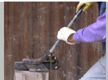
Die wichtigsten Werkzeuge für die Arbeit in Aufbautechnik auf einen Blick: Gießkanne, Gipsbecher, Baueimer, Gummihandschuhe, Modellierholz, Spachtel, Kelle, Sprühflasche, Schraubstock, Bolzenschneider, Hammer, Stahlrohr, Zollstock, Rosenschere, Arbeitshandschuhe. Der Schraubstock und das Rohrstück helfen beim Biegen der Moniereisen. Damit lassen sich auch kurze Enden noch packen und recht scharfwinklig abknicken.
