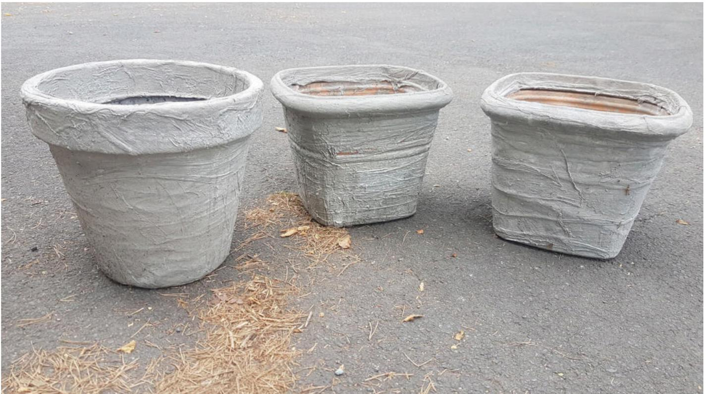
Tränkt man dünne Baumwollgaze in einen Zementleim, bestehend aus Wasser und dem Fließzement CEM-FLUP, so kann man damit beliebige Gegenstände einkleiden, wie z.B. diese Blumentöpfe aus Kunststoff. Das Ergebnis ist eine sehr leichte, harte und witterungsbeständige Außenhülle aus Beton, die man durch Auftragen von weiteren dünnen Betonschichten noch glätten und nach Belieben strukturieren kann.
