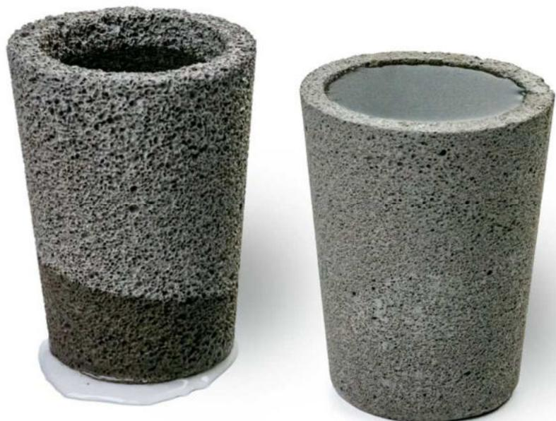
Obwohl er äußerst porös ist, kann Porenleichtbeton durch Zugabe von Hydrophobiermittel auch wasserdicht gemacht werden. Der rechte Becher wurde mit PREN abgedichtet.
